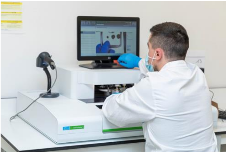
(automate Panthera-Puncher™ 9 de Perkin Elmer permettant de traiter les prélèvements de sang réalisés sur buvard)
